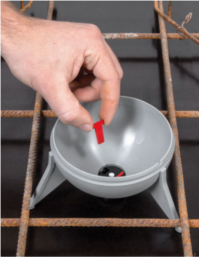
Die Sperrstifte verhindern das Aufschwimmen der Kapsel. Neu: Integrierte Markierung zur präzisen Ausrichtung.
