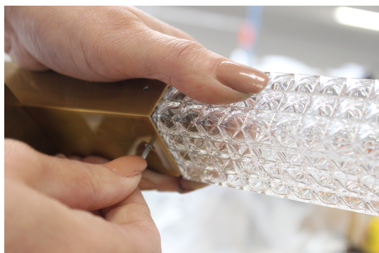
5. Stringere il grano sul lato posteriore. Screw the grain on the back.
